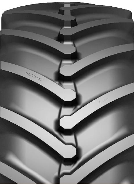
Рисунок протектора разработан в соответствии с современными тенденциями и уровнем конструирования сельскохозяйственных шин, отвечающим перспективным требованиям, предъявляемым к радиальным шинам, обеспечивает высокую самоочищаемость и тягово-сцепные характеристики шины, низкое удельное контактное давление шины на почву, минимальные потери на качение, что позволяет снизить расход топлива.
