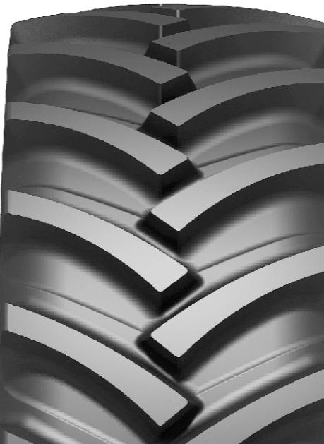
Рисунок протектора выполнен в соответствии с учётом специфики применения данной шины на трактора большой мощности и обеспечивает движение сельхозмашин как по грунтам, так и по дорогам с твёрдым покрытием. Разработанный рисунок протектора обеспечивает высокую самоочищаемость и тягово-цепные характеристики, низкое удельное контактное давление на почву, минимальные потери на качение, что позволяет снизить расход топлива.
