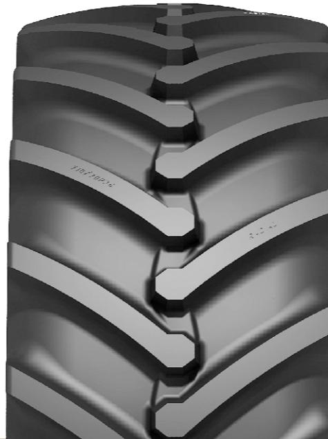
Рисунок протектора разработан в соответствии с современными тенденциями и уровнем конструирования сельскохозяйственных шин, отвечающим перспективным требованиям, предъявляемым к радиальным шинам, обеспечивает высокую самоочищаемость и тягово-цепные характеристики шины, низкое удельное давление шины на почву, минимальные потери на качение, что позволяет снизить расход топлива.
